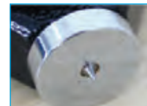
D: Kegelspitze, 30°, SR 0,1 mm Sharp cone point, 30°, SR 0,1 mm
